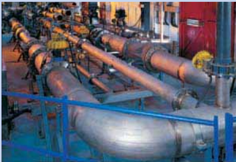
Áramlásmérő kalibráló berendezés, Spirax Sarco, Cheltenham, UK.
